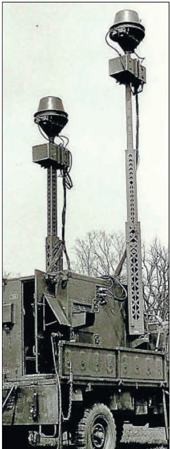
Mobiler Einsatz: Mit diesen MLQ-Peilgeräten der Fernmeldekompanie konnten Standorte und Bewegungen gegnerischer Truppen aufgeklärt werden.
