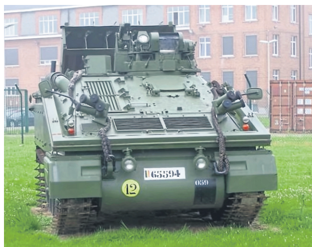
Ein belgischer Jagdpanzer „Striker“ aus britischer Produktion mit einem Anti-Panzer-Raketenwerfer als Aufsatz.
